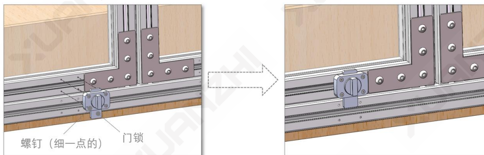
I - 用细一点的螺钉将门锁进行固定 注意螺钉不要拧太紧
