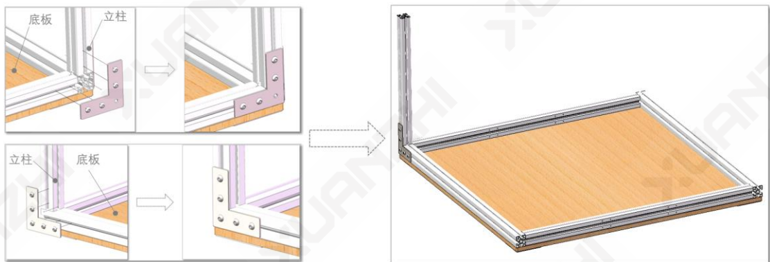
II - 将挂好螺钉和滑块螺母的连接板用来固定好立柱和底板 再依次固定好剩下的 3 根立柱
