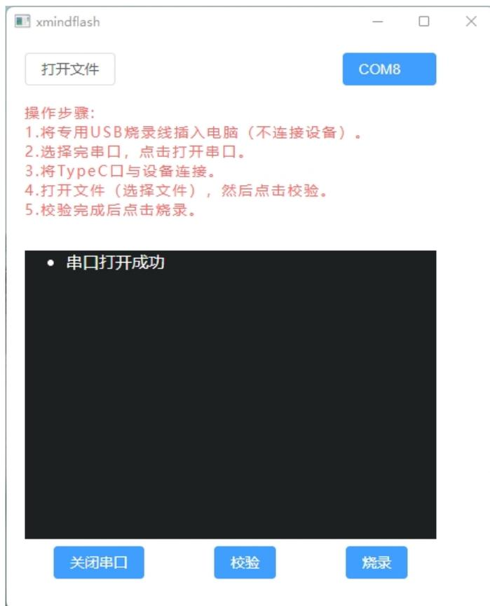
6. 将Type-C口与主控器连接，烧录线Type-C口有字的一面朝向主控器灯，此时显示“串口连接成功”，主控器黄灯长亮
